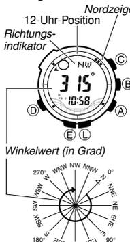
1. Während die Armbanduhr auf den Digitalkompass-Modus geschaltet ist, legen Sie die Armbanduhr auf einer ebenen Fläche ab oder, wenn Sie die Armbanduhr an Ihrem Handgelenk tragen, achten Sie darauf, dass Ihr Handgelenk horizontal (gegenüber dem Horizont) ausgerichtet ist.
