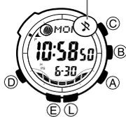
Wenn einer der Knöpfe der Uhr betätigt wird, ertönt ein Bedienungskontrollton. Dieser Kontrollton kann beliebig ein- und ausgeschaltet werden.
