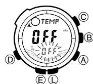
1. Drücken Sie den Knopf (B), um den Barometer/Thermometer-Modus aufzurufen.
