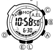
Ein Elektrolumineszenz-Panel (EL-Panel) beleuchtet das Zifferblatt der Armbanduhr, damit Sie dieses auch im Dunkeln einfach ablesen können. Der automatische Beleuchtungsschalter dieser Armbanduhr sorgt für eine automatische Beleuchtung des Zifferblattes, wenn Sie die Armbanduhr unter einem bestimmten Winkel auf Ihr Gesicht richten.
