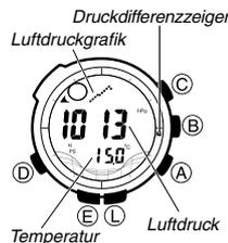
Drücken Sie den Knopf (B) im Zeitnehmungsmodus oder in einem beliebigen anderen Sensormodus, um auf den Barometer/Thermometer-Modus zu schalten und automatisch mit den Luftdruck- und Temperaturmessungen zu beginnen.
