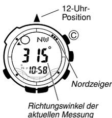
3. Drücken Sie im Zeitnehmungs-, Digitalkompass-, Barometer/Thermometer- oder Höhenmesser-modus den Knopf (C), um eine Kompassmessung vorzunehmen.
